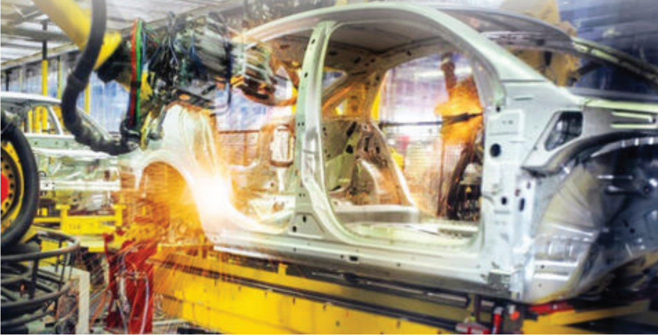
یک ربات صنعتی در حال کار روی چارچاس یک خودرو در یک کارخانه تولیدی
